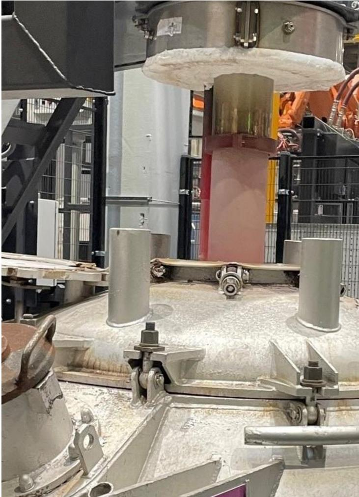
Der Energieaufwand für das reine Warmhalten von bis zu 6.000 kg flüssigen Aluminium, liegt im Bereich von 20-30 kW und stellt im Vergleich zu dauerhaften 60 kW bei gasbeheizten Anlagen, eine deutliche Reduzierung dar. Der Vorteil im Verbrauch aber auch in dem – vor Ort - nicht vorhandenen CO<sub>2</sub> Ausstoß, stellen einen entscheidenden Kosten-Vorteil für den Anwender dar.
